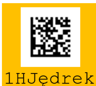
Abbildung: Beispiel-DataMatrix mit codiertem polnischen Namen mit ISO8859-2 Character „ę“.
